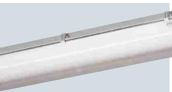
Luminario fluorescente totalmente rediseñado con cuerpo inyectado en ABS color gris, estabilizado contra rayos UV y auto extingüible, difusor de policarbonato transparente prismatizado interiormente para mayor eficiencia lumínica, alta resistencia al impacto. El conjunto garantiza una producción al polvo y la humedad grado IP65
